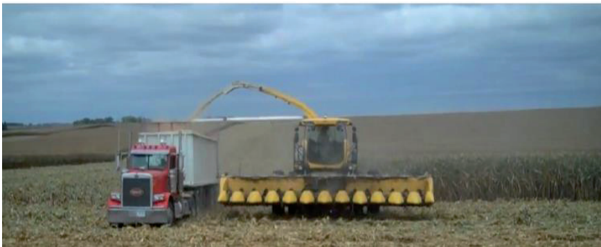
Figura 2. Colhedora de forragem autopropelida adaptada para colheita de snaplage. Fonte: Arquivo pessoal (Gustavo Salvati).
