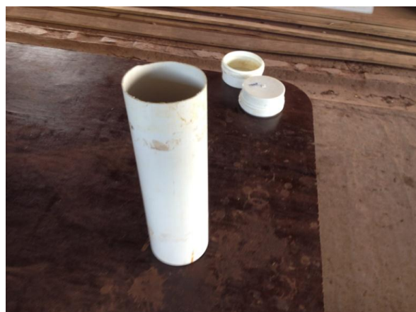
FIGURA 1 - Mini-silos experimentais para receber a ensilagem do milho.
