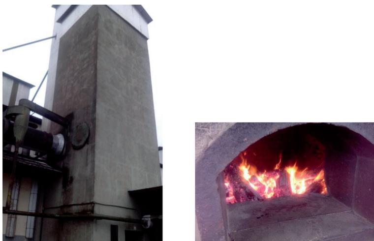
**Figura 1.** Secador contínuo de fluxo misto de cavaletes com corpo em alvenaria (a) e a fornalha a lenha do mesmo equipamento (b).
