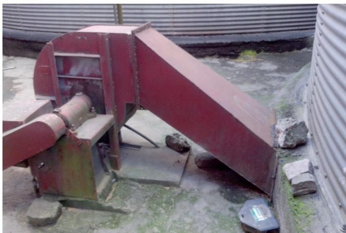
**Figura 10.** Ventilador mal projetado e transição muito pior.
